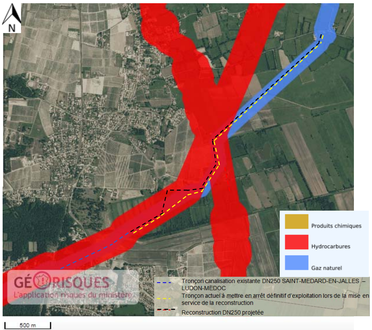
Figure 17 : Canalisations de transport de matières dangereuses – Canalisation projetée DN250 SAINT MEDARD EN JALLES – LUDON MEDOC (source : www.georisques.gouv.fr – Mars 2021)
